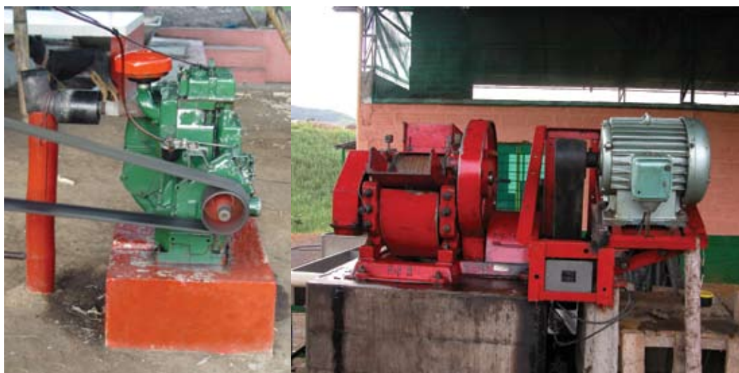
FIGURA 22. Motores diesel y eléctrico empleados para accionar molinos paneleros.
