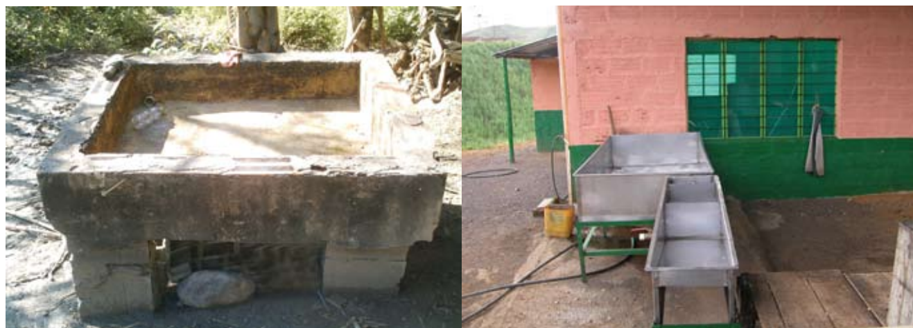
FIGURA 42. Pozuelo tradicional y en acero inoxidable diseñado por CORPOICA para lavado de gaveras.
