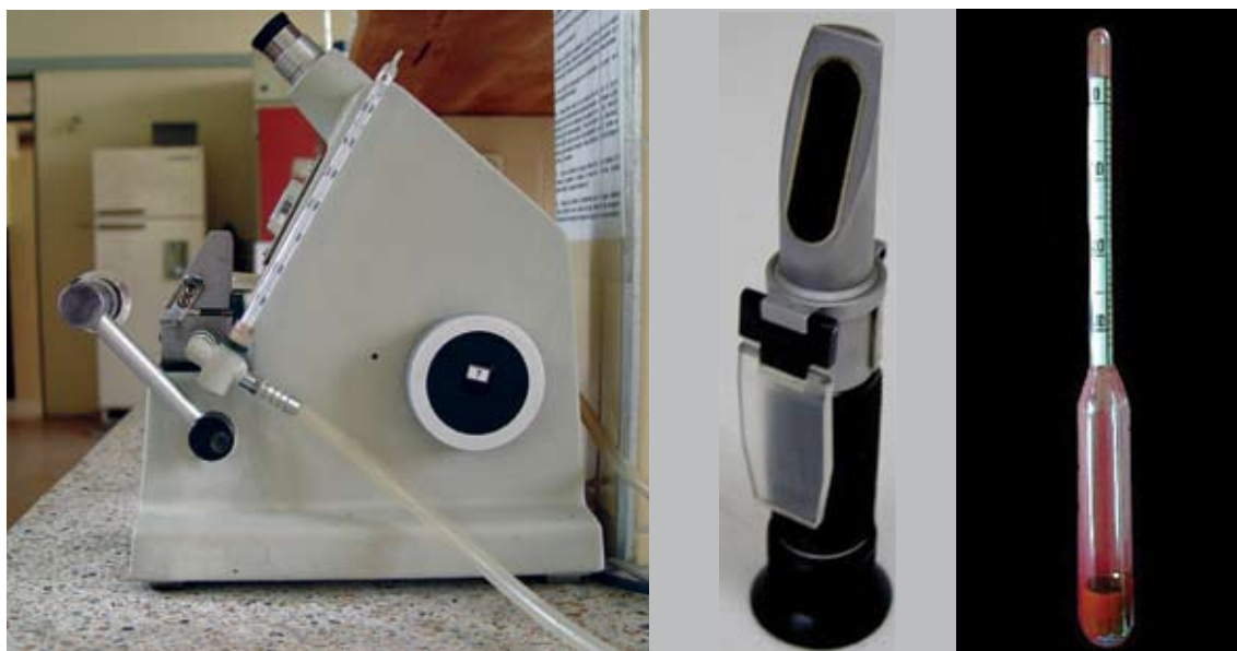
FIGURA 16. Refractómetro de laboratorio, refractómetro de campo y sacarímetro.
