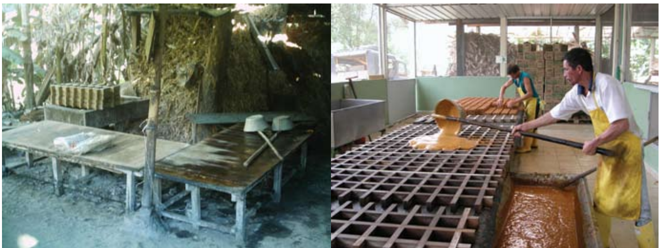
FIGURA 37. Área para el batido y moldeo en un trapiche tradicional y mejorado por CORPOICA.
